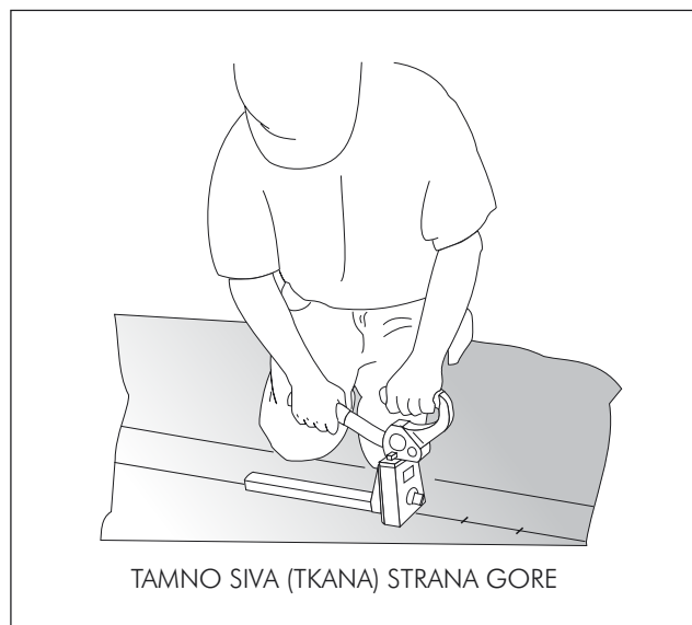
Slika 1.2 - Pričvrstite role međusobno mehaničkim pričvršćivačima (za podložni beton), odnosno spojnicama (ako nema podložnog betona)
